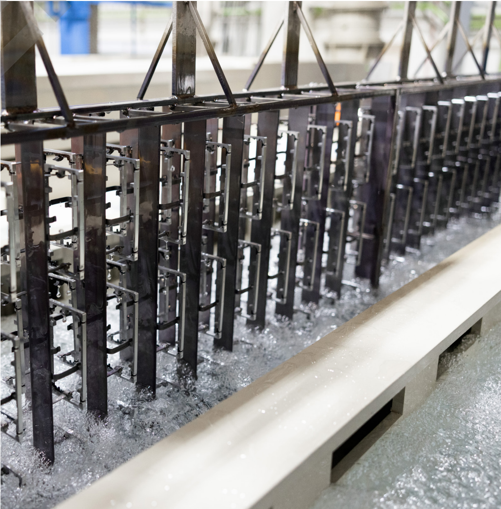
Wir haben unsere Initiative fortgesetzt, die darauf abzielt, unsere elektrochemischen Metallveredelungsverfahren zu verbessern und zu unterstützen, wie z. B. das Eloxieren, das das Potenzial hat, jährlich Hunderte Millionen Liter Wasser einzusparen, wenn es in großem Maßstab angewendet wird.
